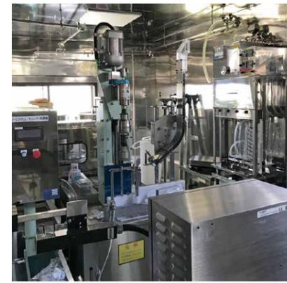
ラボ内の様子。原液とRO水をタンク内で混ぜてから容器に注入する。容器にラベルを貼るなどの手作業も行っている
